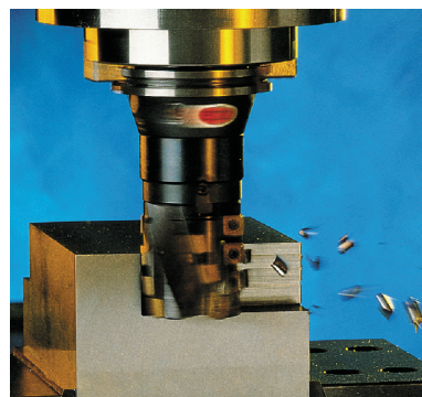
Power-Fräsen mit Graflex® modularem System: Zerspanvolumen 432 cm³/min
